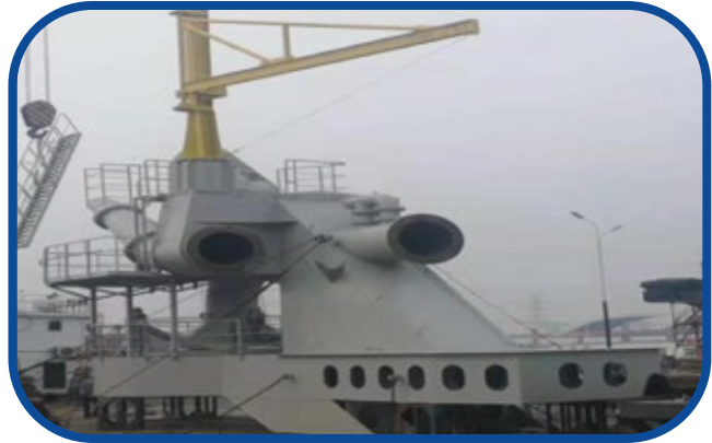
ESTRUCTURA DE SOPLADO DE PROA DE LA DRAGA (JAN DE NUL PROJECT)
